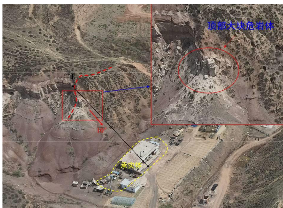
照片 4.2-18 崩塌 B18（镜向 30^{\circ} ）——庙梁小长沟水库坝体西侧崩塌 高程 (m)
