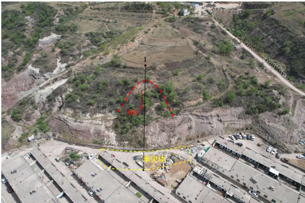
照片 4.2-31 滑坡 H02（镜向 160°）——温家崙加油站对面社区滑坡
