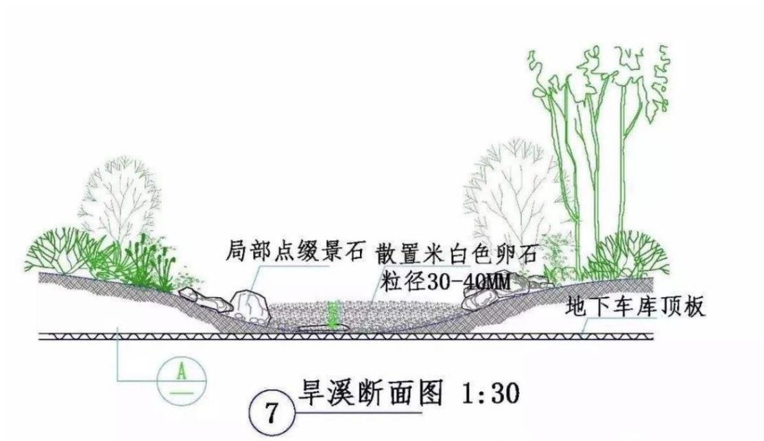
图 5.5-4 旱溪结构示意图 1
